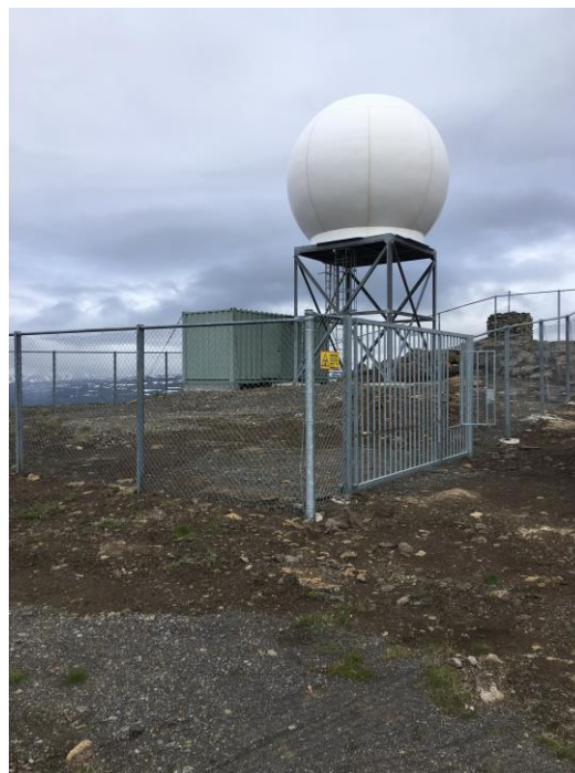
EEC C-band veðursjá á Fljótsdalsheiði. Var áður í eigu varnarliðsins á Keflavíkurflugvelli. Ljós. Hermann Arngrímsson 8. júlí 2016.
